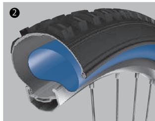
■タイヤの片側をリムに取り付けます。チューブを少し膨らませ、リムのバルブ穴にバルブを通し、チューブをタイヤに入れます。
