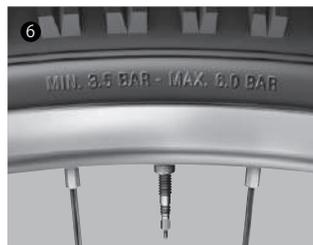
■圧力計を使用して空気圧を調整します。許容空気圧範囲は、タイヤのサイドウォールに記されています。
