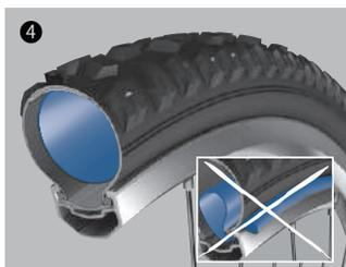
■バルブの反対側から、タイヤのもう一方の側面をリムにはめチューブとタイヤの間に挟まれていないことを確認してください。
